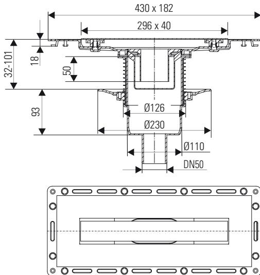
Ablaufleistung nach DIN EN 1253 TAB. 3, (20 mm Anstauhöhe), in Verbindung mit DIN EN 274
